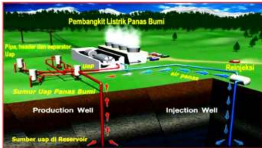
Gambar 7.4. : Diagram contoh lay out PLTP
