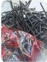
Paku Ukuran 3 cm dan 5 cm untuk bambu Ukuran 7 cm dan 10 cm untuk rangka
