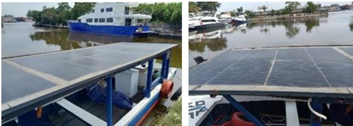
Gambar 3. Kondisi PV pada atap perahu nelayan yang berdebu dan pecah.
