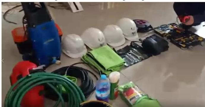
**Gambar 10.** Peralatan yang dibutuhkan dalam perawatan PLTS
