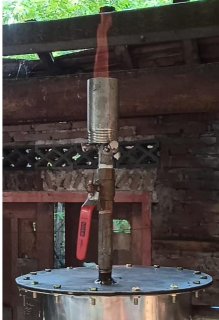
Gambar 19. Proses Gasifikasi Dalam Reaktor
